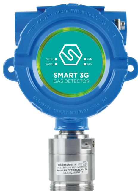
Le détecteur de gaz Smart3G-C2-LD est conçu pour répondre aux exigences industrielles; le boîtier est antidéflagrant et peut être installé en milieu ATEX zone 1 et, lorsqu'il est équipé d'un adaptateur anti-poussière, en zone 21. L'élément de détection est logé dans une tête en acier inoxydable. Les capteurs pellistor utilisés pour la détection des gaz inflammables présentent une excellente linéarité de sortie jusqu'à 100% LIE et un temps de réponse rapide.
