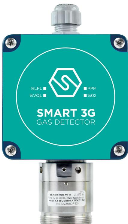
Le détecteur de gaz SMART3G-C3 est conçu pour répondre aux exigences industrielles ; le boîtier est antidéflagrant et peut être installé en zone ATEX 2 et, lorsqu'il est équipé d'un adaptateur anti-poussière, en zone 22. L'élément sensible est placé dans une tête en acier inoxydable de 48 mm de diamètre. Les capteurs infrarouges utilisés pour la détection des gaz inflammables et réfrigérants sont protégés contre l'empoisonnement, avec une grande précision et une longue durée de vie.
