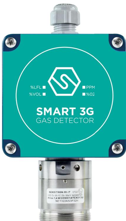
Le détecteur de gaz SMART3G-C3 est conçu pour répondre aux exigences industrielles ; le boîtier est antidéflagrant et peut être installé en zone ATEX 2 et, lorsqu'il est équipé d'un adaptateur anti-poussière, en zone 22. L'élément sensible est placé dans une tête en acier inoxydable de 47,5 mm de diamètre. Les capteurs PID utilisés pour les composés organiques volatils sont capables de détecter une concentration de gaz inférieure à celle de la plupart des autres technologies.
