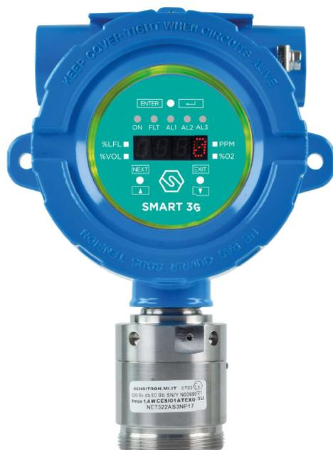
Le détecteur de gaz SMART3G-C2 est conçu pour répondre aux exigences industrielles ; le boîtier est antidéflagrant et peut être installé en milieu ATEX zone 1 et, lorsqu'il est équipé d'un adaptateur anti-poussière, en zone 21. L'élément de détection est placé dans une tête en acier inoxydable.
