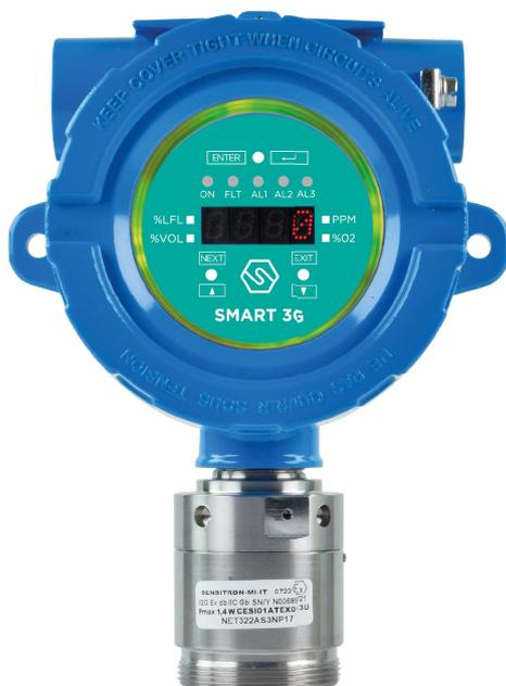
Le détecteur de gaz SMART3G-D2 est conçu pour répondre aux exigences industrielles ; le boîtier est antidéflagrant et peut être installé en zone ATEX 1 et, lorsqu'il est équipé d'un adaptateur anti-poussière, en zone 21. L'élément de détection est placé dans une tête en acier inoxydable d'un diamètre de 48 mm. Les capteurs infrarouges utilisés pour la détection des gaz inflammables et réfrigérants sont protégés contre l'empoisonnement, avec une grande précision et une longue durée de vie.
